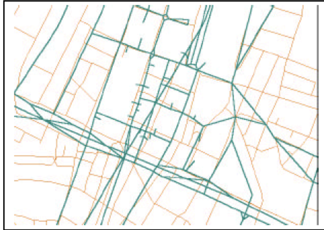
Фигура 1. Пример на верен дигитален модел на пътна мрежа (кафяво) и неточен модел на пътна мрежа (зелено).
